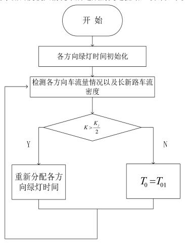
根据上面建立的道路实际通行模型,以及结合长新路与安宁东路实际情况,比如车道,初始红绿灯时间等,建立红绿灯最优配时模型。
